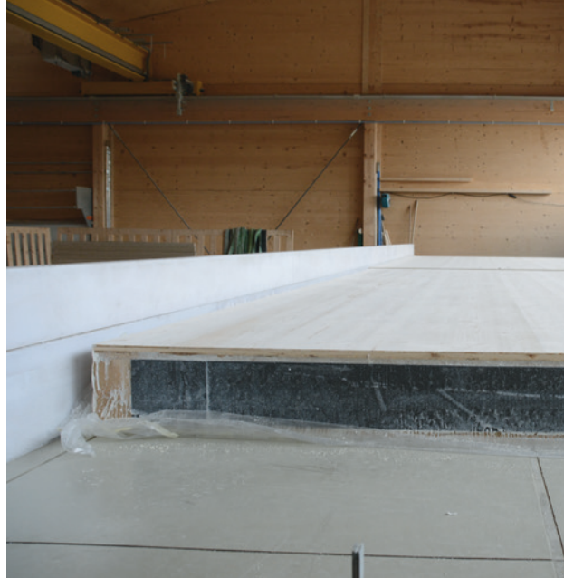
Holzelemente in der Vakuumpresse
