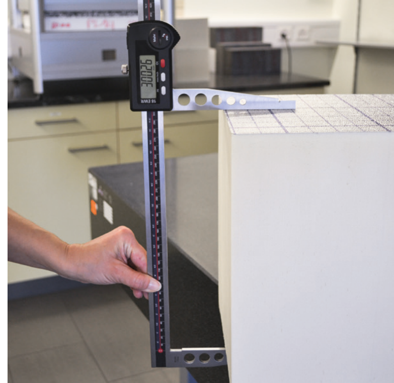
300 mm, der europaweite "Dicken-Rekord" für eine fertig produzierte PIR-Dämmstoffplatte.
